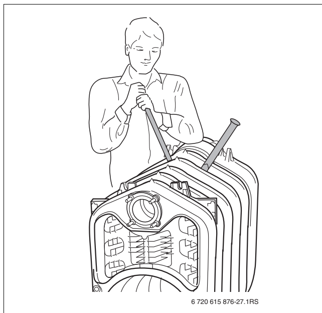
Fig. 27 Separación del cuerpo de caldera
